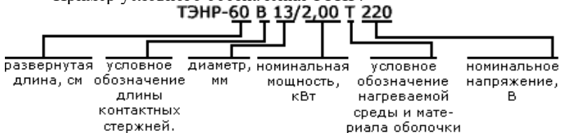
Рисунок 7.1 - Геометрические параметры ТЭНРа
