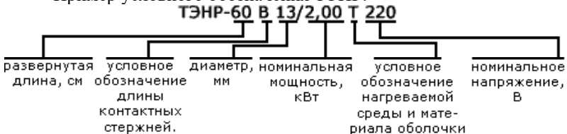
Рисунок 7.1 - Геометрические параметры ТЭНРа
