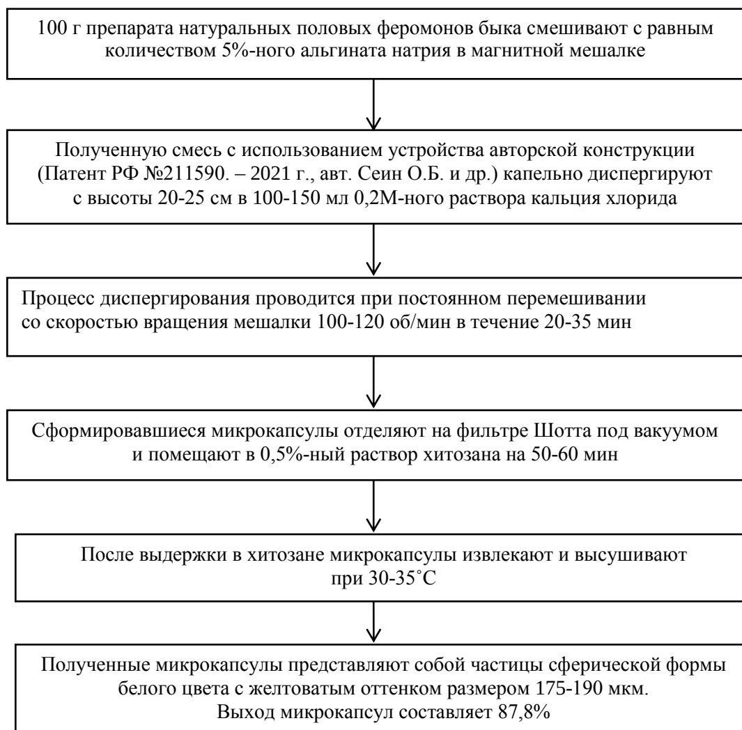
Рисунок 1 – Схема технологического процесса микрокапсулирования половых феромонов быка
