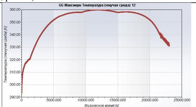
Рис. 2. Изменение температура в течение дня внутри гелиосушилки для фруктов
