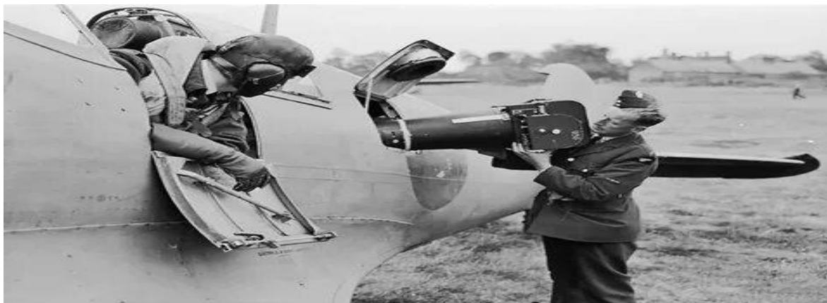
2-rasm. Aerosyomka jarayonini amalga oshirishda plyonkali fotoapparatni samolyotga o'rnatish jarayoni.
