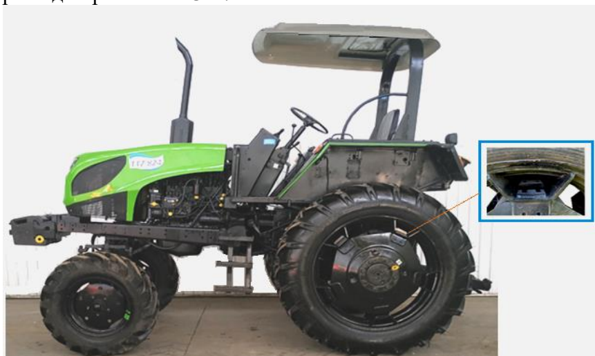
Рис.1. Опытный образец трактора, снабженный устройством бесступенчато регулируемой колеи задних колес на необходимое междурядье
