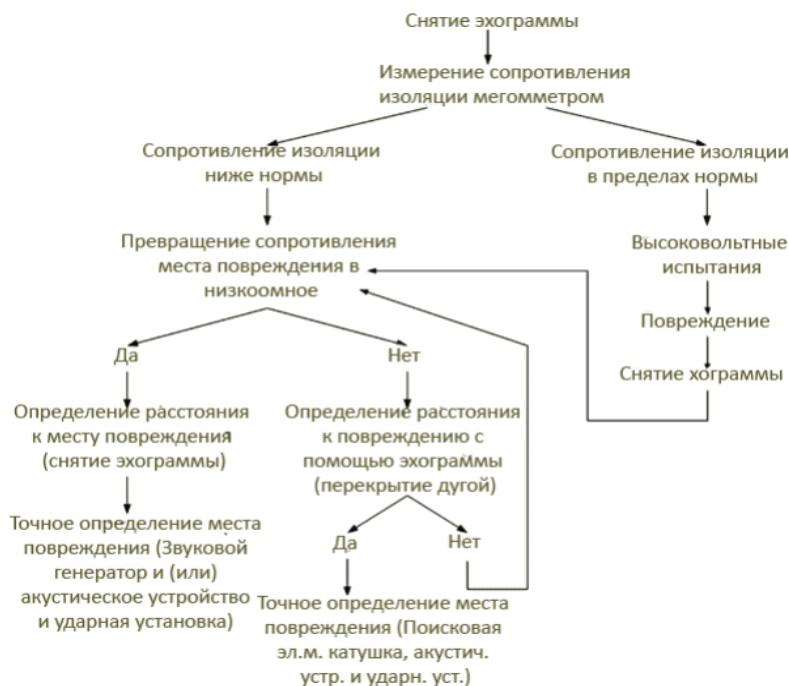
Рисунок 3 - Алгоритм поиска мест повреждения на КЛ
