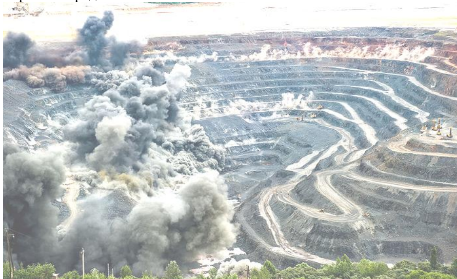
Рисунок 1 - Взрывные работы в карьере Михайловского железорудного комбината
