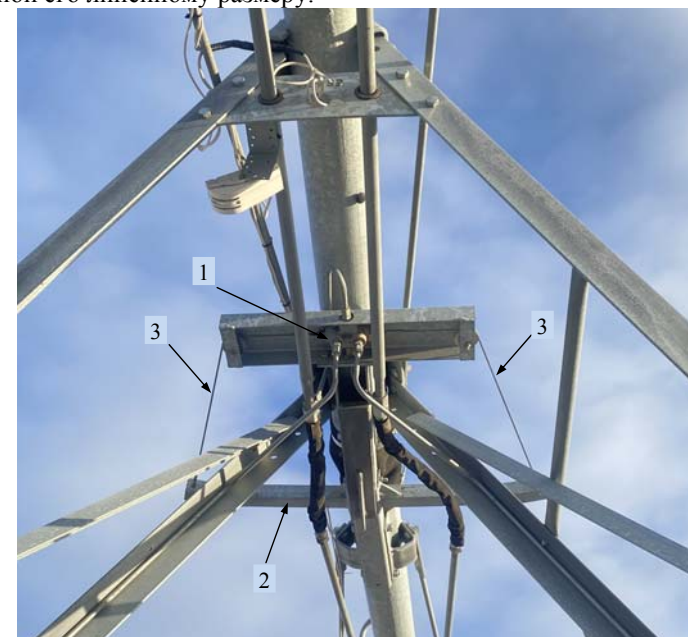
Рисунок 1 – Общий вид системы контроля выравнивания движения опорной тележки дождевальной машины T-L Irrigation Company
