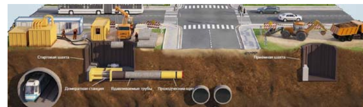
Рис. 2. – Выполнение работ методом микротоннелирования [7]
