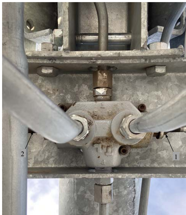
Рисунок 2 – Общий вид распределителя потока золотникового типа фирмы T-L системы выравнивания движения опорной тележки
