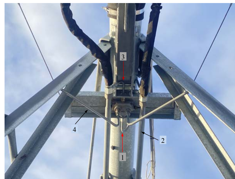
Рисунок 3 – Участки трубопроводов системы контроля выравнивания
