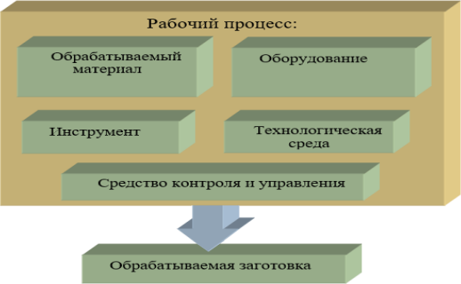
Рисунок 1 – Структурная схема технологической подсистемы первого уровня
