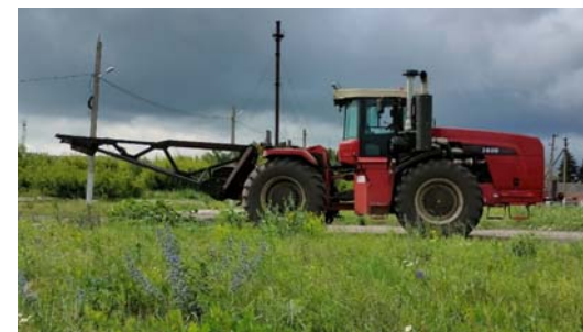
Рисунок 3 - Испытуемый трактор с зацепленным имитационным орудием
