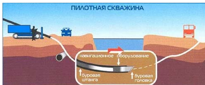
Рис. 1. Бурение пилотной скважины
