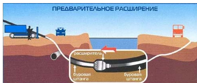
Рис. 2. Расширение отверстия скважины
