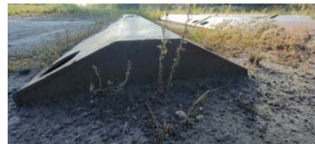
Рисунок 1 - Препятствие для испытания сельскохозяйственной техники
