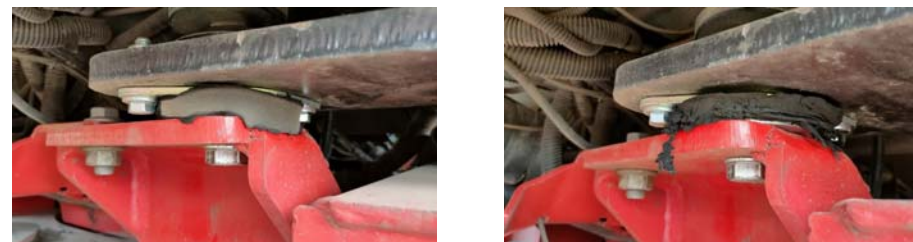
Рисунок 6 - Отказ каучуковых подушек амортизации кабины
