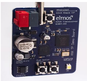
Рисунок 1 – Пример платы приемопередатчика использующейся в коммутационных шинах
