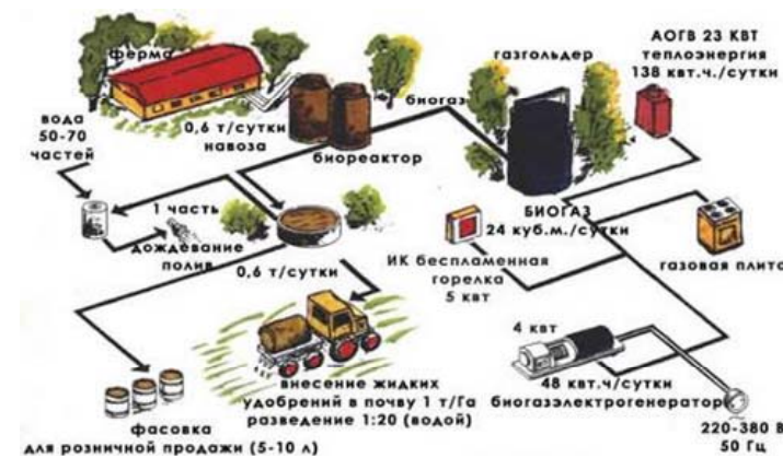
Рисунок 1 - Схема и размещение рассматриваемой установки на сельскохозяйственной ферме
