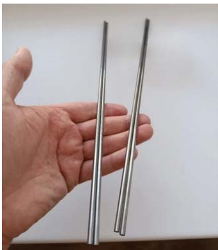
Рисунок 3 – Электроды W-85% Co-15% для электроискрового легирования
