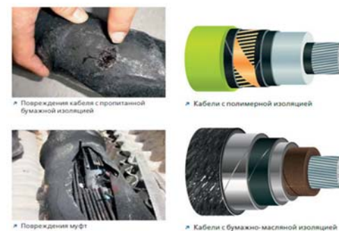
Рисунок 3 – Повреждения и виды изоляционных материалов
