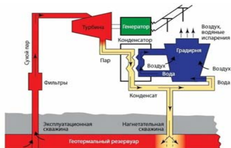
Рисунок 4 – Схема применения геотермальной энергии
