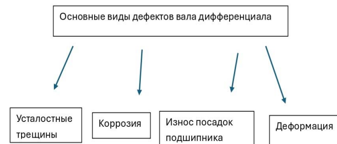
Рисунок 1 – Основные виды дефектов вала дифференциала
