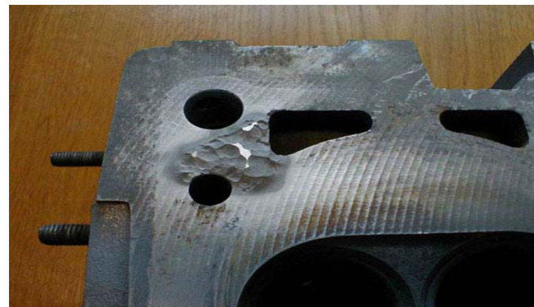
Рис.2 – Восстановленная пробоина на алюминиевой ГБЦ
