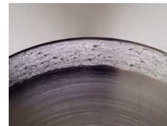
Рис. 4 - Вид поверхности трения диска после испытания композита TiC-C-Al
