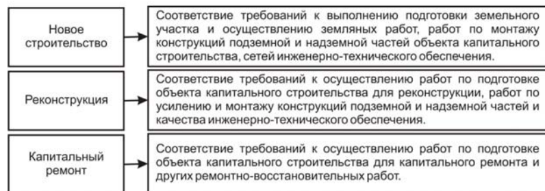
Рисунок 1 – Проверки основных видов ремонтно-строительных работ
