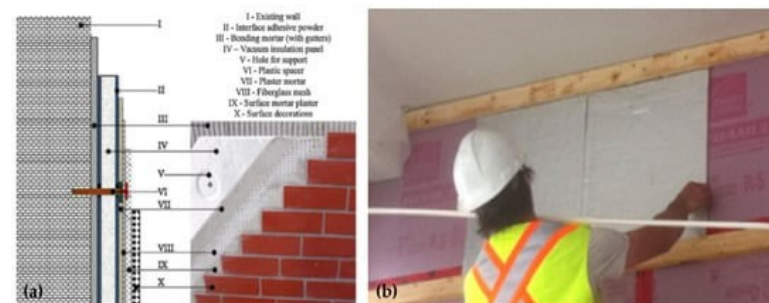
Рис. 2. Схема и монтаж вакуумной теплоизоляционной панели: а - схема системы; б - монтаж системы
