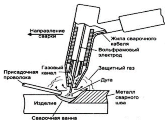
Рисунок 4. Технология возведения сварочного шва методом TIG.
