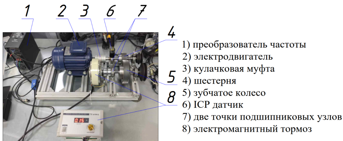
Рисунок 1 – Стенд экспериментальной установки, моделирующий зубчатую передачу
