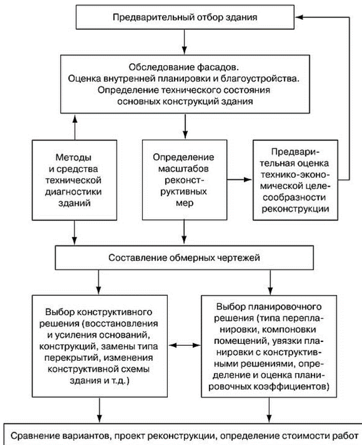
Рисунок 1. Последовательность проектирования реконструкции здания
