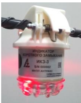
Рисунок 1 – Указатель поврежденного участка, подвешенный к фазному проводу
