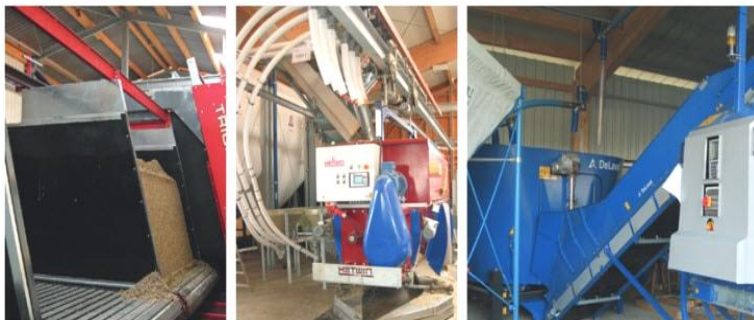
Рисунок 2 - Слева - бункер для предварительного хранения; по середине - рельсовый кормосмеситель и кормораздатчик; справа - стационарный миксер и кормораздатчик на рельсах
