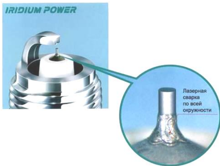
Рисунок 2. Соединение иридиевого наконечника.
