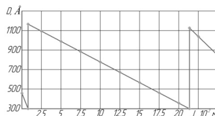
Рисунок 4 – Изменение величины блоков в зависимости от пути трения при давлении 50 \text{ кг/мм}^2 ( +23 \text{ кг/мм}^2 )
