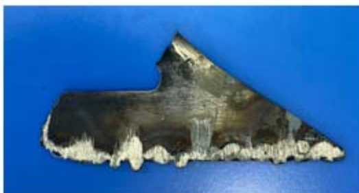
Рисунок 2 – Образец лемеха плуга после дуговой наплавки
