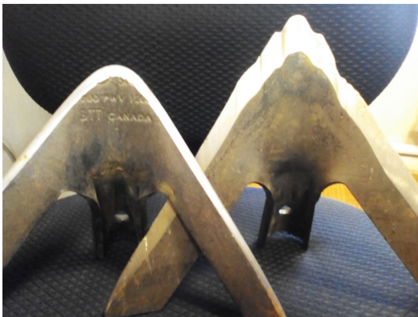
Рисунок 1 – Фото новой и изношенной стрельчатой лапы культиватора
