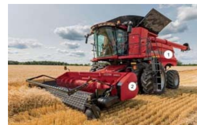
Рисунок 3 – Раздельный способ подбор и обмолот зерноуборочным комбайном: 1 – зерноуборочный комбайн; 2 – подборщик
