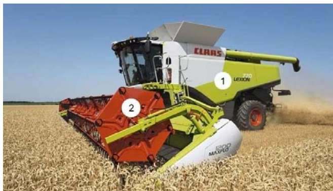
Рисунок 1 – Технологический процесс прямого комбайнирования с помощью зерноуборочного комбайна: 1 – зерноуборочный комбайн; 2 – жатка для зерновых культур
