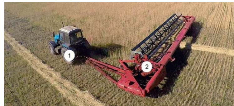
Рисунок 2 – Двухфазная технология уборки, скашивание и укладка в валок: 1 – трактор; 2 – валковая жатка
