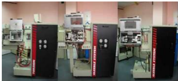
Рисунок 1. Основные элементы системы GLEEBLE 3800
