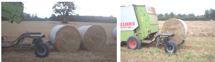
Рисунок 1 – Накопитель: а – выгрузка в паре; б – перевозка одного рулона
