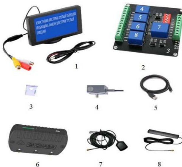
Рис. 3. Вариант набора комплекса дистанционного автоматизированного диагностирования технического состояния МКПП
