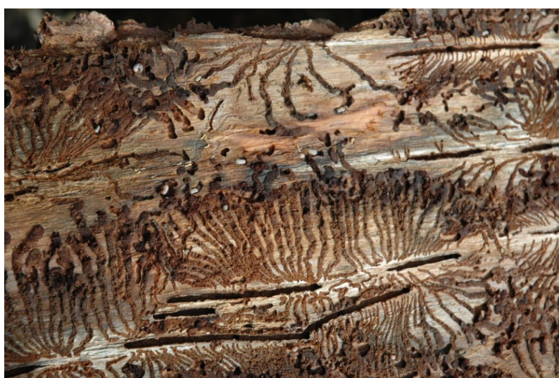
Рисунок 4 – Поражение дерева жуками-точильщиками
