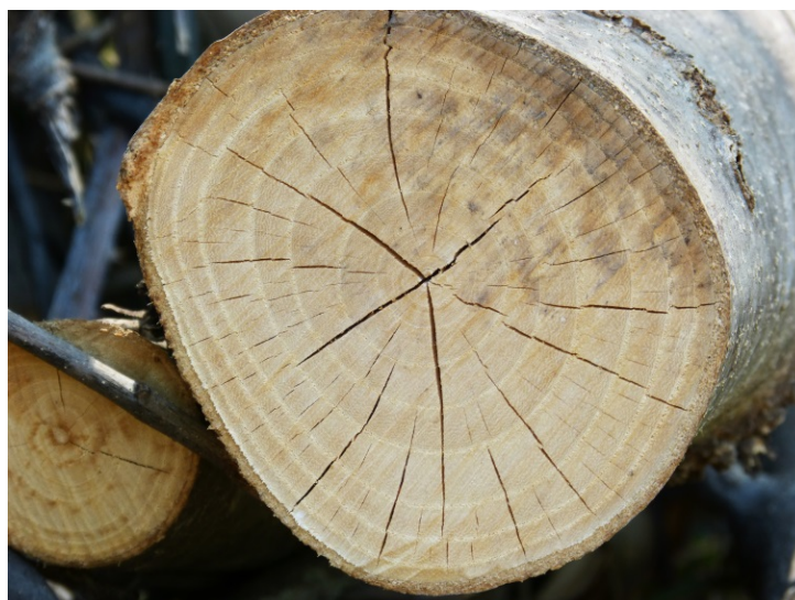
Рисунок 8 - Трещины на годичных кольцах (чеки)
