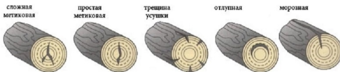
Рисунок 6 – Виды трещин в древесине
