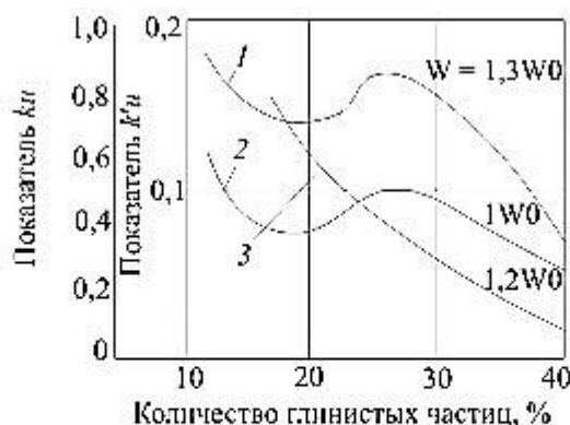
Рисунок 1 - Влияние содержания в грунтах глинистых частиц на их тиксотропное разупрочнение: 1, 2 – при вибрации частотой 50 Гц; 3 – при одиночном ударе
