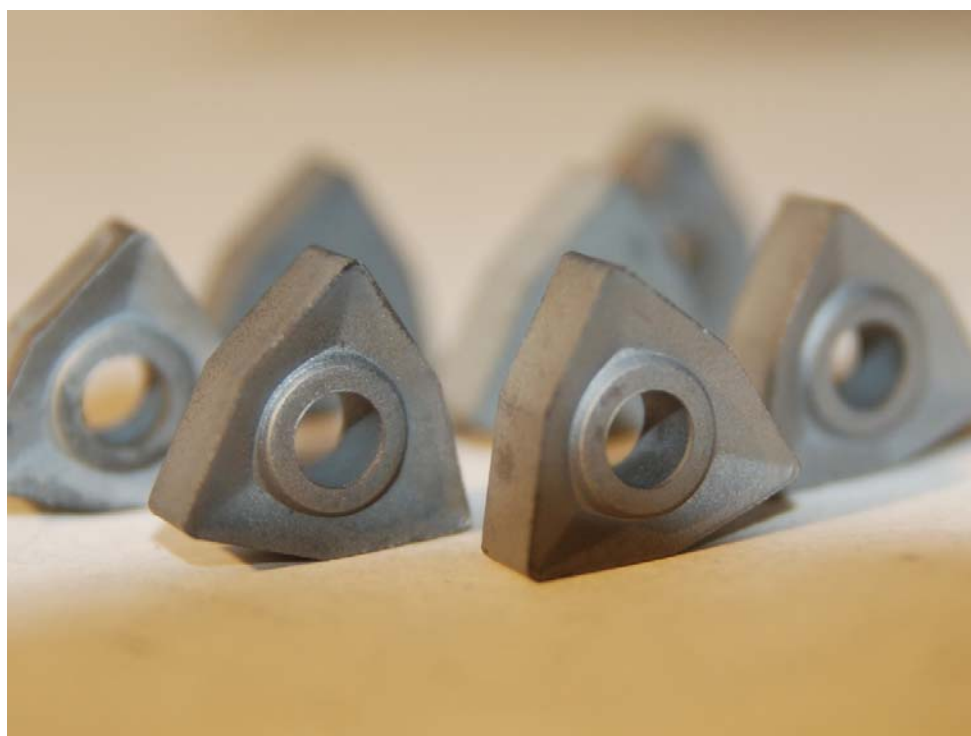
Рисунок 1 – Внешний вид токарных пластин ТН20
