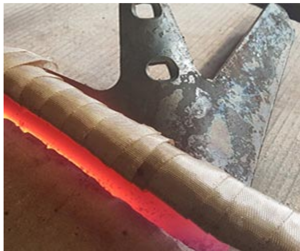
Рисунок 2 – Закалка стрелчатой лапы культиватора токами высокой частоты
