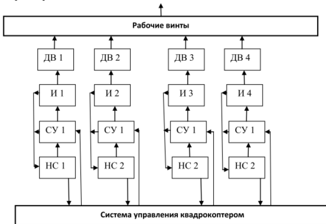
Рис.1. Структурная схема модели управления электроприводами на базе БДПТ в квадрокоптере
