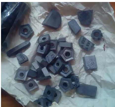
Рисунок 1- Неликвидные пластины из сплава Т30К4
