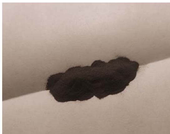
Рисунок 2 – Электроэрозионный порошок из сплава Т30К4
