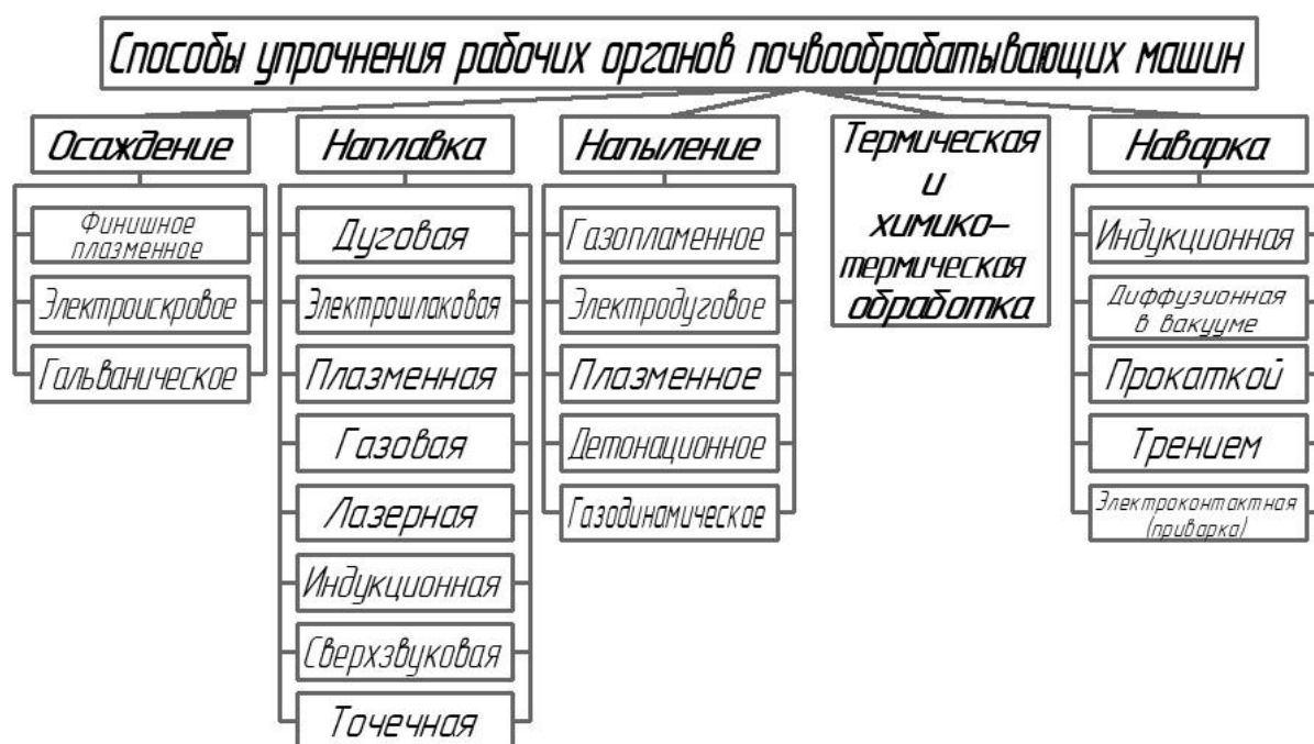
Рисунок 3 - Способы упрочнения рабочих органов почвообрабатывающих машин
