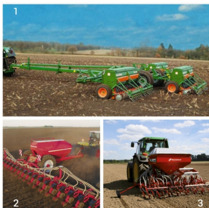
Рисунок 2 - Виды сеялок: 1) квадратно-гнездовая; 2) с пунктирной посадкой; 3) рядовая.
