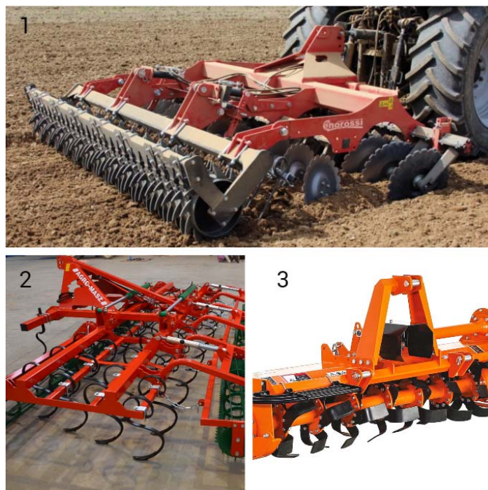
Рисунок 3 – виды культиваторов: 1) дисковый; 2) лемешный; 3) фрезерный
