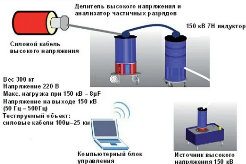
Рисунок 2 – Схематическое изображение системы OWTS
