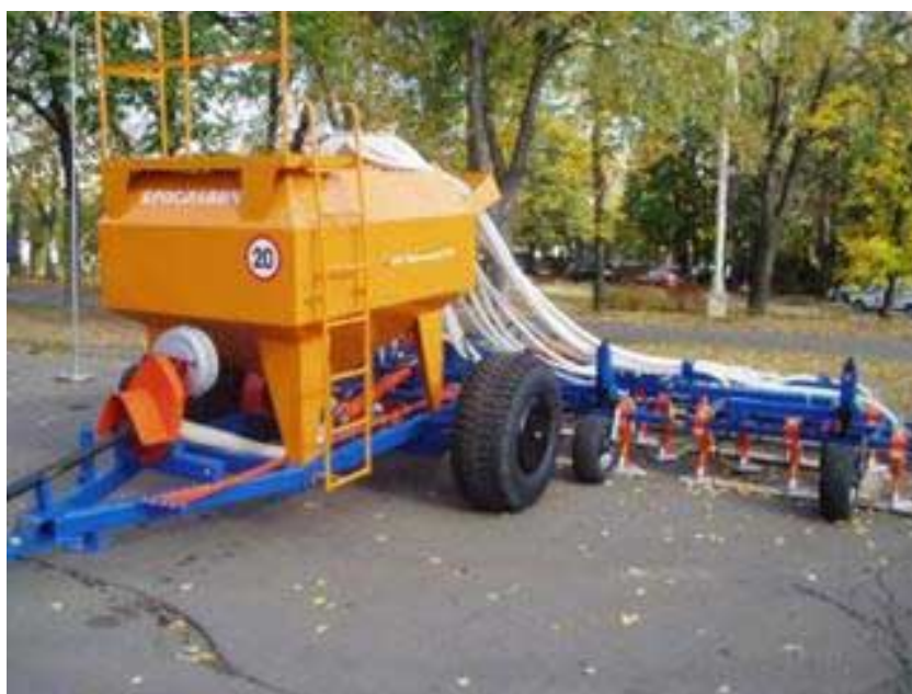
Рисунок 2. Почвенно-посевной агрегат ППА-7,2 "Ярославич"
