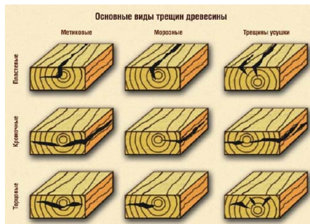
Рис. 3. Основные виды трещин древесины
