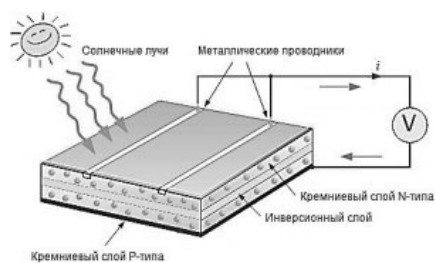
Рис. 1. Конструкция солнечной панели
