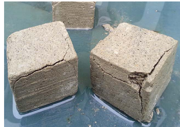
Рисунок 2 – Разрушение бетонных конструкций под воздействием перепадов температур
