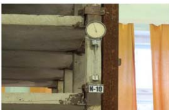
Рисунок 1 – Крепление индикатора к колонне
