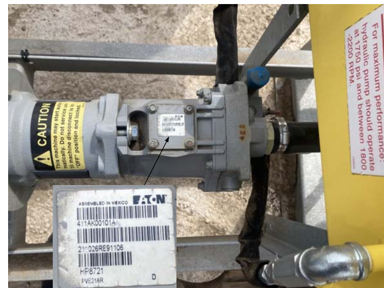
Рисунок 1 – Общий вид поршневого насоса типа 411AK00101A PVE21AR
