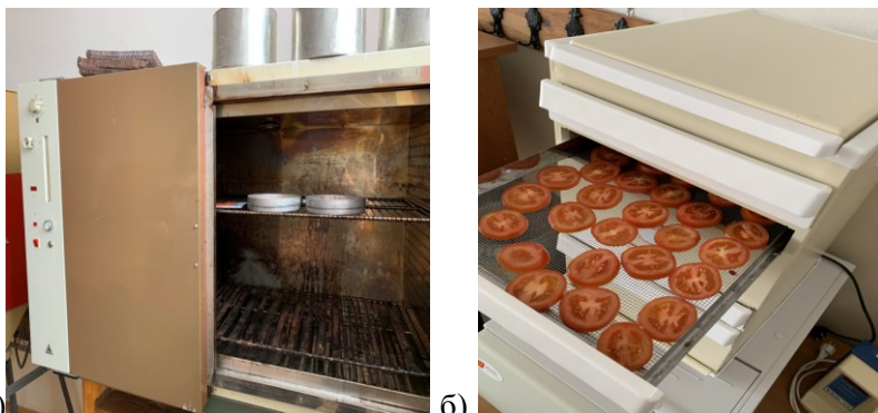
Рисунок 1 - Внешний вид конвективной сушки (а) и инфракрасной сушки (б)
