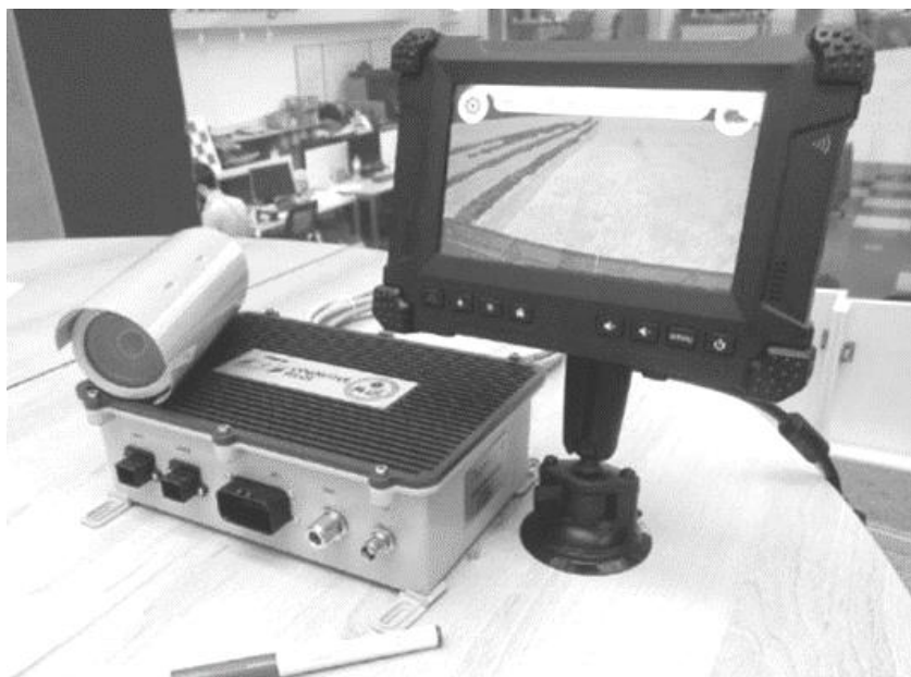
Рисунок 1 – Устройство системы «Cognitive Agro Pilot»
