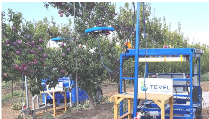
Рисунок 4 – Специализированные летающие автономные роботы для сборки урожая
