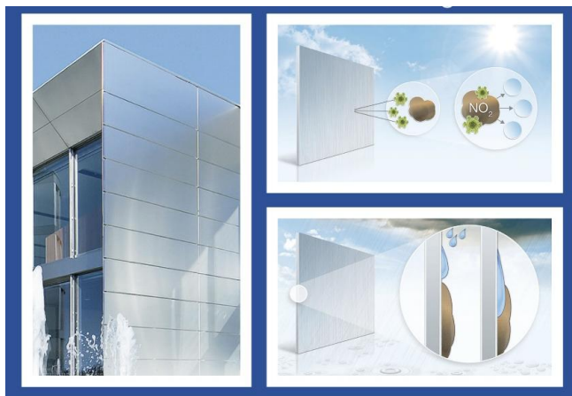
Рисунок 1 – Принцип работы «EcoClean» покрытия
