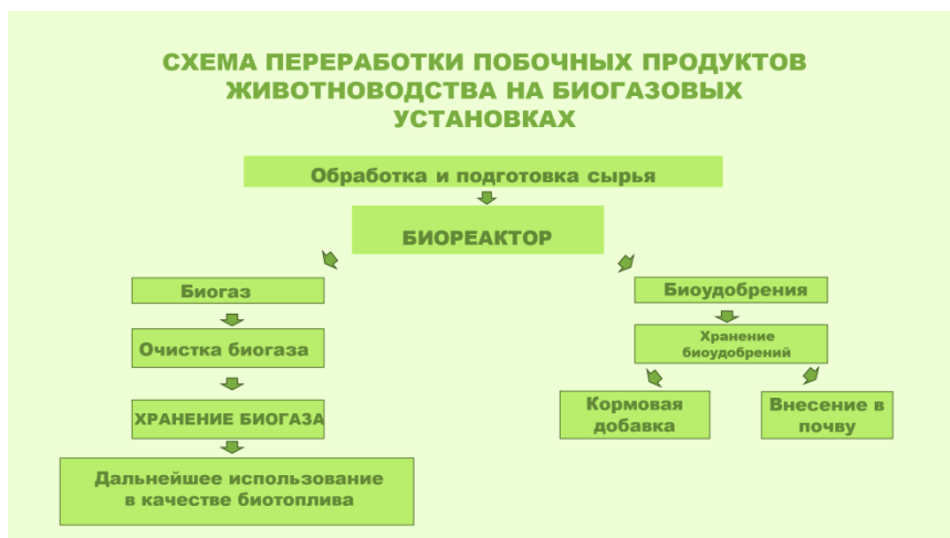
Рисунок 1 – Схема переработки побочных продуктов животноводства на биогазовых установках
