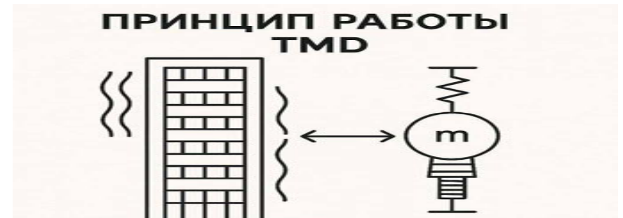
Рисунок 2. Принцип работы tuned mass damper (TMD). Масса m движется в противофазе колебаниям здания, гася их.
