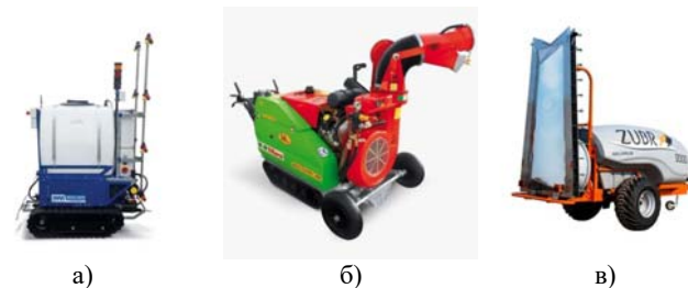
Рис. 4. Роботы-опрыскиватели [1-3]: а) М.М.SRL DOMINATOR RSR-E, б) TIFONE CRA, в) СелАгро ЗУБР ПВ "Колонна" 3.0
