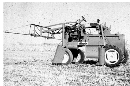
Рис. 2. Заднеприводный опрыскиватель с передним расположением штанги
