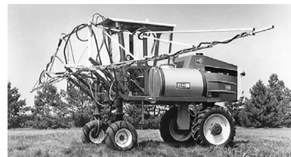
Рис. 3. Первый самоходный опрыскиватель с гидравлическим приводом и активной подвеской Hagie 440
