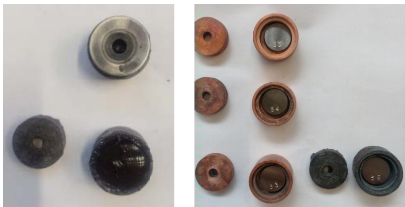
Рис. 1. Подготовка и нанесение графитовой пасты на образцы
