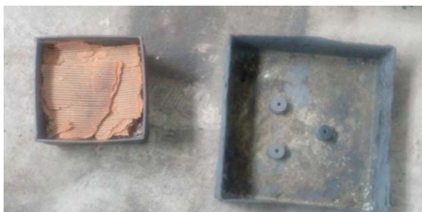
Рис. 2. Образцы после обработки в карбюризаторе и без него (контрольные образцы)
