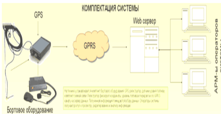
Рисунок 1 - Аппаратно-программные средства системы мониторинга техники
