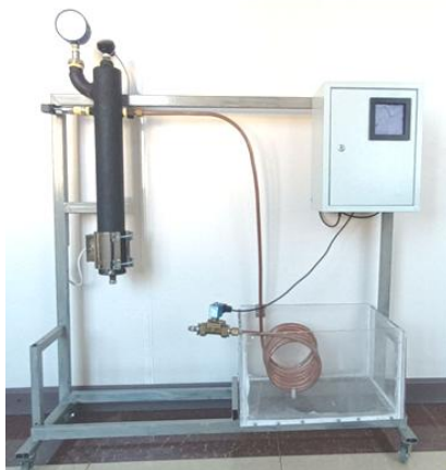
Рисунок 1 - Внешний вид учебно-лабораторного стенда по изучению процессов регулирования температуры и давления на базе ОВЕН ПЛК150
