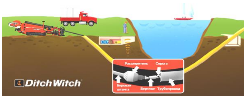
Рисунок 2 – Расширение пилотной скважины
