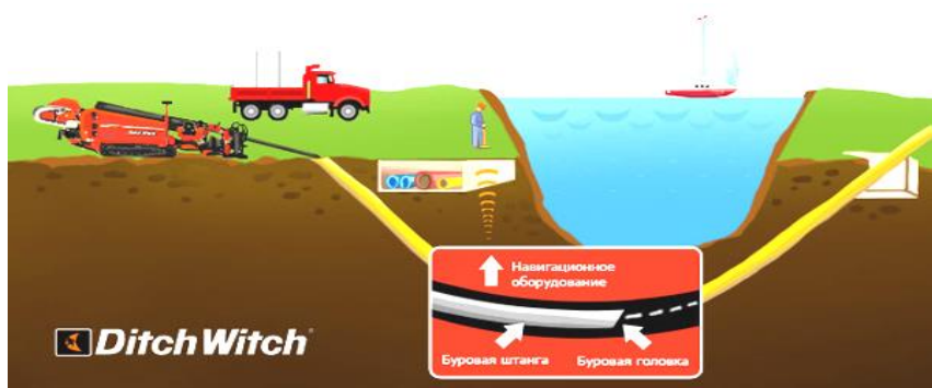
Рисунок 1 – Бурение пилотной скважины
