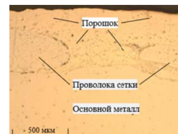
Рисунок 7. Микроструктура зоны соединения, полученного ЭКП металлической тканой сетки с порошком ПР-Х11Г4СР в ячейках со сталью 45 ( \times 300 )
