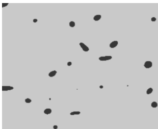
Рисунок 8. Результаты исследования пористости покрытия, полученного ЭКП металлической тканой сетки с порошком ПР-Х11Г4СР в ячейках со сталью 45 ( \times 600 )
