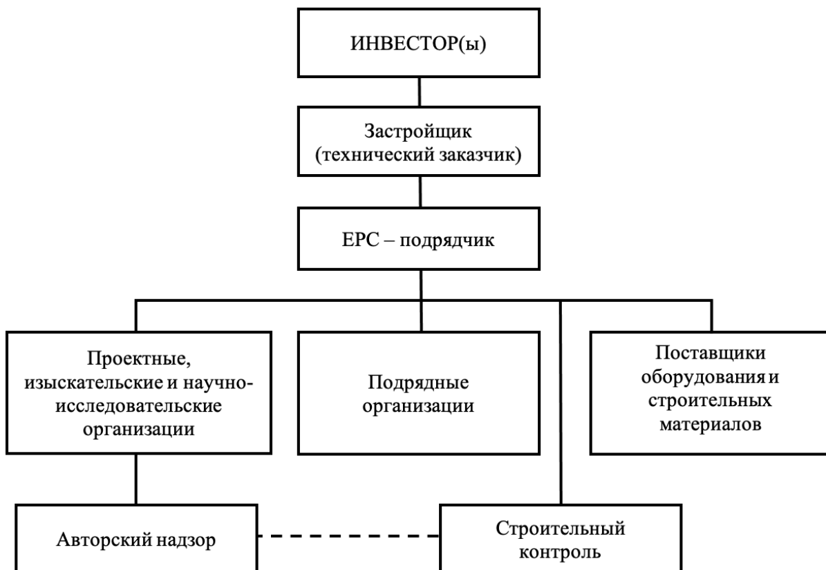
Рис. 2. Схема управления строительством «под ключ» (ЕРС-подряд)
