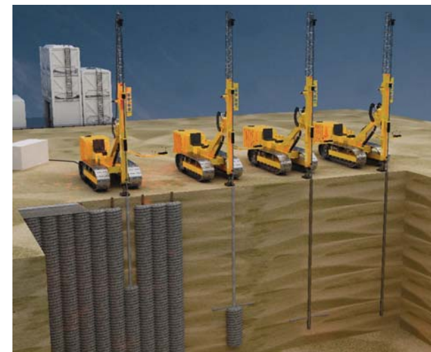
Рисунок 1 – Принципиальная схема производства работ при струйной цементации по технологии Jet Grouting
