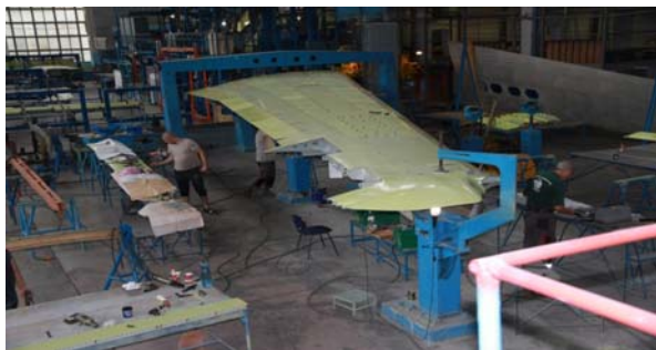
Рисунок 2 – Участок фрезеровки стыковочного профиля кессона КЧК.
