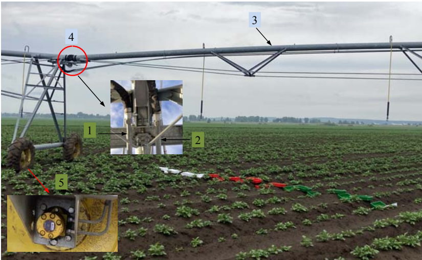
Рисунок 4 – Фрагмент участка основного трубопровода с опорной тележкой и узлом выравнивания широкозахватной дождевальной машины кругового движения компании T-L Irrigation Company
