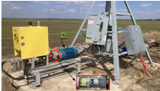
Рисунок 1 – Общий вид участка гидравлической системы подачи дождевальной машины T-L Irrigation Company кругового движения
