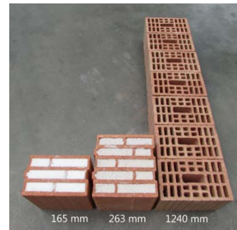
Рис.4. Сравнение обычного кирпича с кирпичом, заполненным аэрогелем
