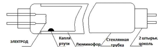
Рисунок 1 – устройство люминесцентной лампы
