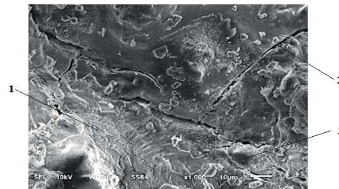
Рисунок 1. Растровая микрофотография геополимерных композиционных материалов при 1000-кратном увеличении (1 – геополимерное вяжущее; 2 – микротрещина; 3 – микропора)
