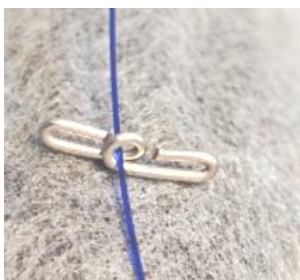
Рисунок 3 – Фиксационный якорь самостоятельного производства
